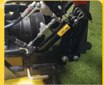
Optionale hydraulische Aushebung für Wartungsstellung Optional hydraulic lift for maintenance position
