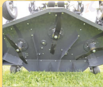
Mähdeck hochklappbar für einfache Wartung Swing-up mower deck for easy maintenance
