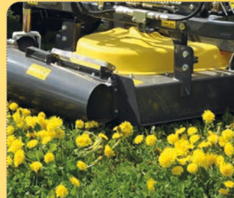
Mähen und Aufnehmen in einem Arbeitsgang Mowing and collecting in one working step
