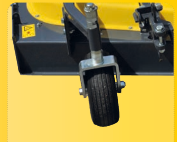
um 360 Grad frei schwenkbare Laufräder mit Spurversatz 360 degree freely-pivoting wheels with track offset
